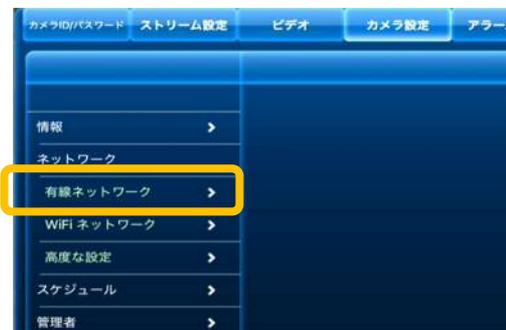
2) [固定 IP]を選択し、〈IP アドレス〉、〈サブネットマスク〉、〈デフォルトゲートウェイ〉、〈DNS サーバー〉を入力します。
