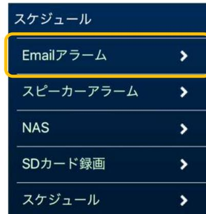
2) [Emailトリガー]をオンにし、検知したい項目に✓を入れます。動体検知を選択した場合、動体検知感度の設定をします。
